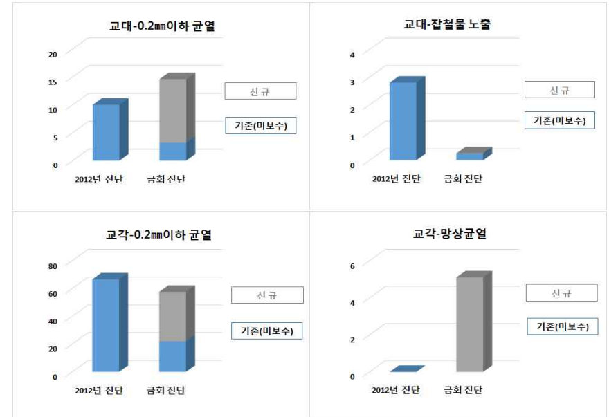
【그림 3.14】교대 및 교각 기 진단결과 비교(여주)
